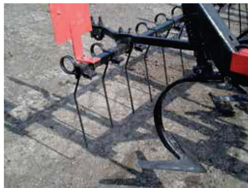
Плоскорежущие лапы и пружинные бороны культиватора КШУ-18
